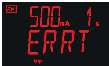
El equipo ha detectado un error en el transformador.
