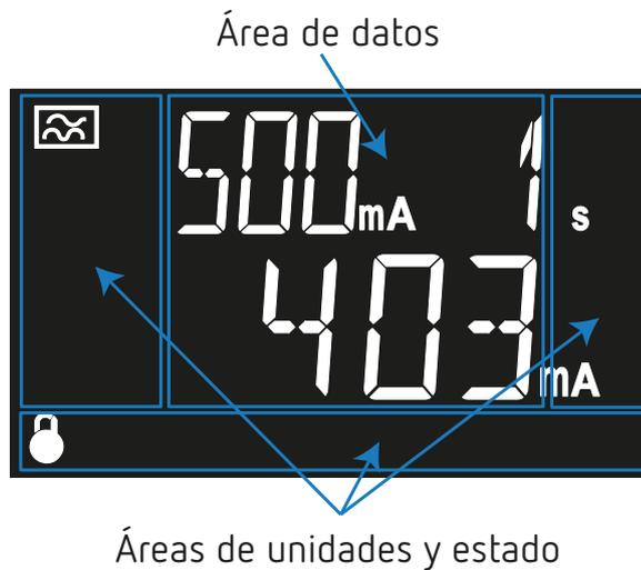
Figura 18: Áreas del display del RGU-10A.
