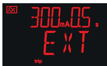
Si se ha generado un disparo utilizando la entrada TRIP/RESET se muestra:
