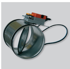
REMP Compuertas motorizadas proporcionales circulares con cuerpo de acero galvanizado y motorización controlada por sonda de CO 2 . El servomotor funciona proporcionalmente a la señal 0-10V enviada por la sonda. Intercalando el módulo BEAS se pueden ajustar las posiciones de apertura mínima y máxima. Se utilizan en los sistemas de ventilación multizona tipo proporcional.
