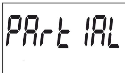
Figura 13: Pantalla principal de las energías parciales.
