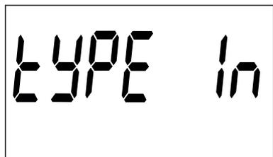
En esta pantalla se selecciona el funcionamiento de la entrada digital: **Count** (como contador de pulsos) o **tariff** (Funcionamiento con Tarifas).
