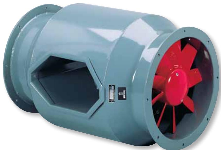
Ventiladores helicoidales tubulares bifurcados, capacitados para trasegar aire a 150°C en continuo, con carcasa de acero laminado, protegida contra la corrosión con pintura poliéster, hélice de aluminio fundido en una sola pieza, motor trifásico, IP55, Clase F, con protector térmico incorporado y rodamientos a bolas de engrase permanente.
