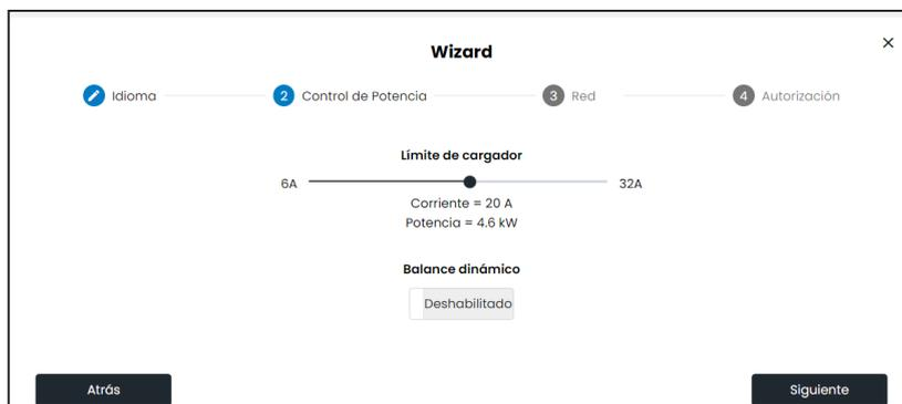
En caso de habilitar el **Balance Dinámico**, se deberá ajustar la corriente contratada en la vivienda. Se debe seleccionar el **Dispositivo de medida de casa**. Se pueden seleccionar las siguientes opciones:
