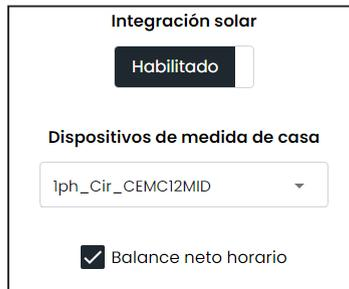
Al habilitar el **Balance Neto Horario**, el equipo gestiona automáticamente la energía excedente de los paneles solares, inyectándola a la red cuando la generación es insuficiente para la recarga de un vehículo eléctrico. La energía inyectada se monitoriza y se recupera antes de que finalice un periodo de 1 hora, permitiendo aprovechar la energía acumulada para realizar la carga del vehículo eléctrico.
