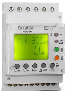
Permite la programación y ajuste de todos los parámetros requeridos para obtener una protección y control de mantenimiento de la instalación completo. Una serie de parámetros que pueden configurarse mediante ajuste directos por teclado (pulsadores) y por menús de configuración en el propio instrumento.
