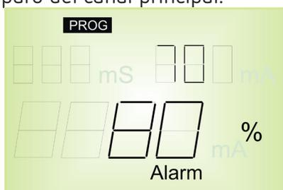
Figura 26: Ajuste de la corriente de prealarma.
