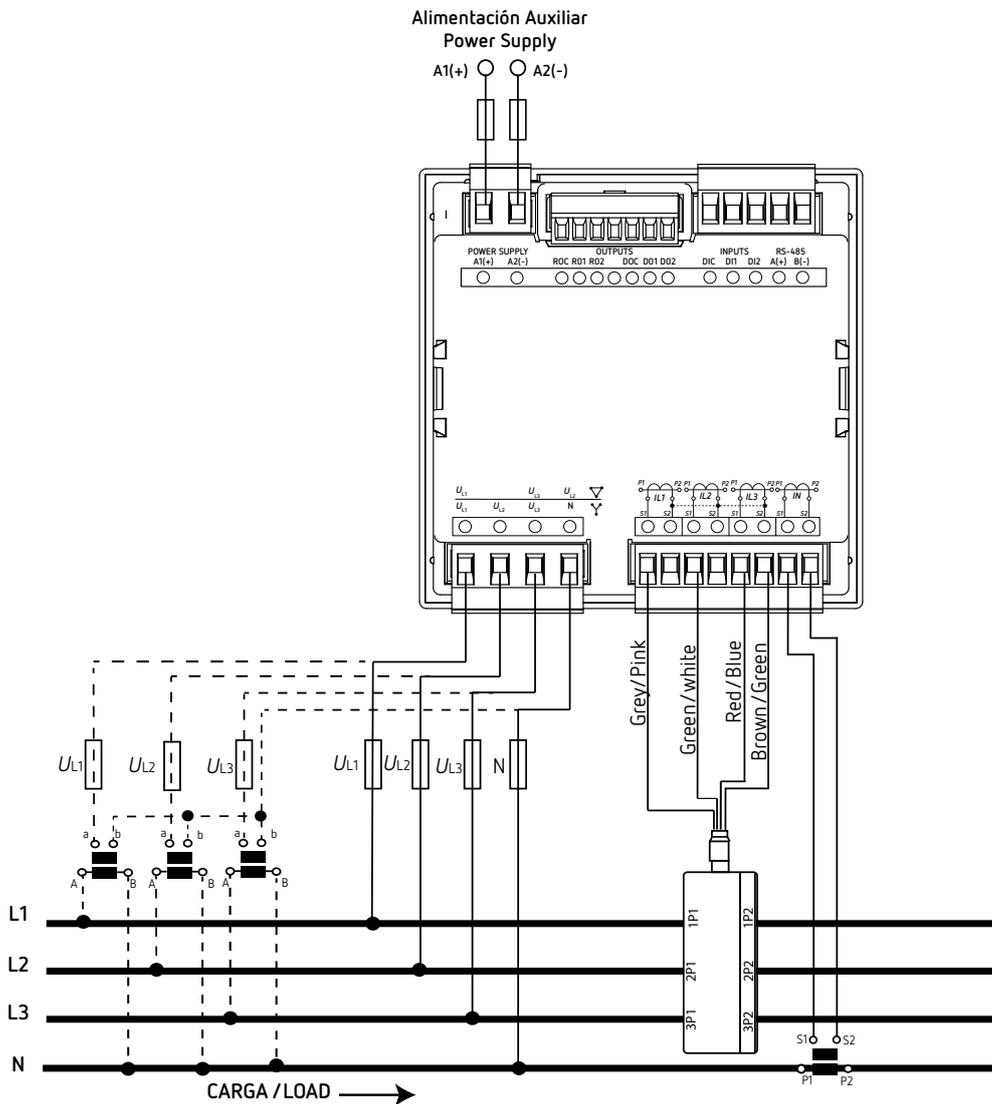
Figura 5: Medida trifásica con conexión a 4 hilos (CVM-C11-MC-IN-485-ICT2).
