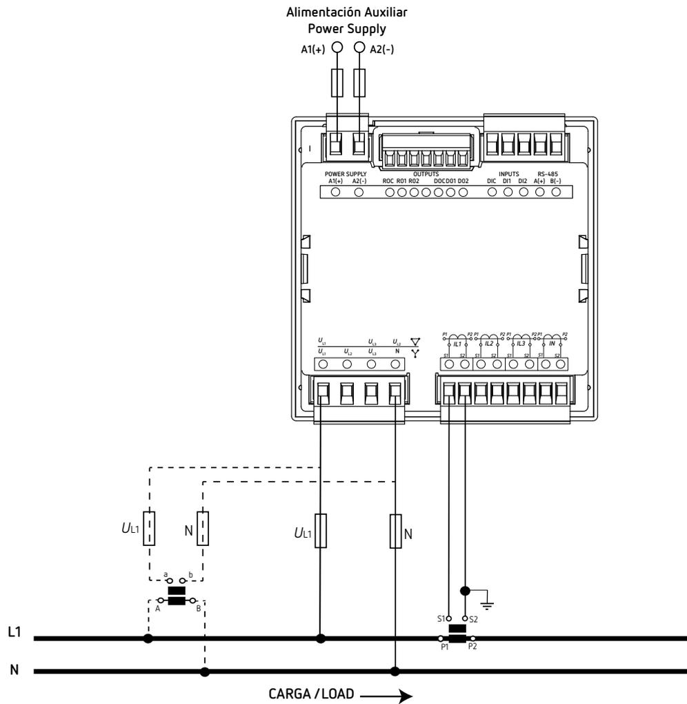
Figura 19: Medida monofásica fase a neutro de 2 hilos (CVM-C11-ITF-IN-xxx-ICT2).
