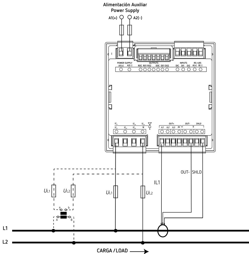
Figura 18: Medida monofásica fase a fase de 2 hilos (CVM-C11-FLEX-IN-485-ICT2).
