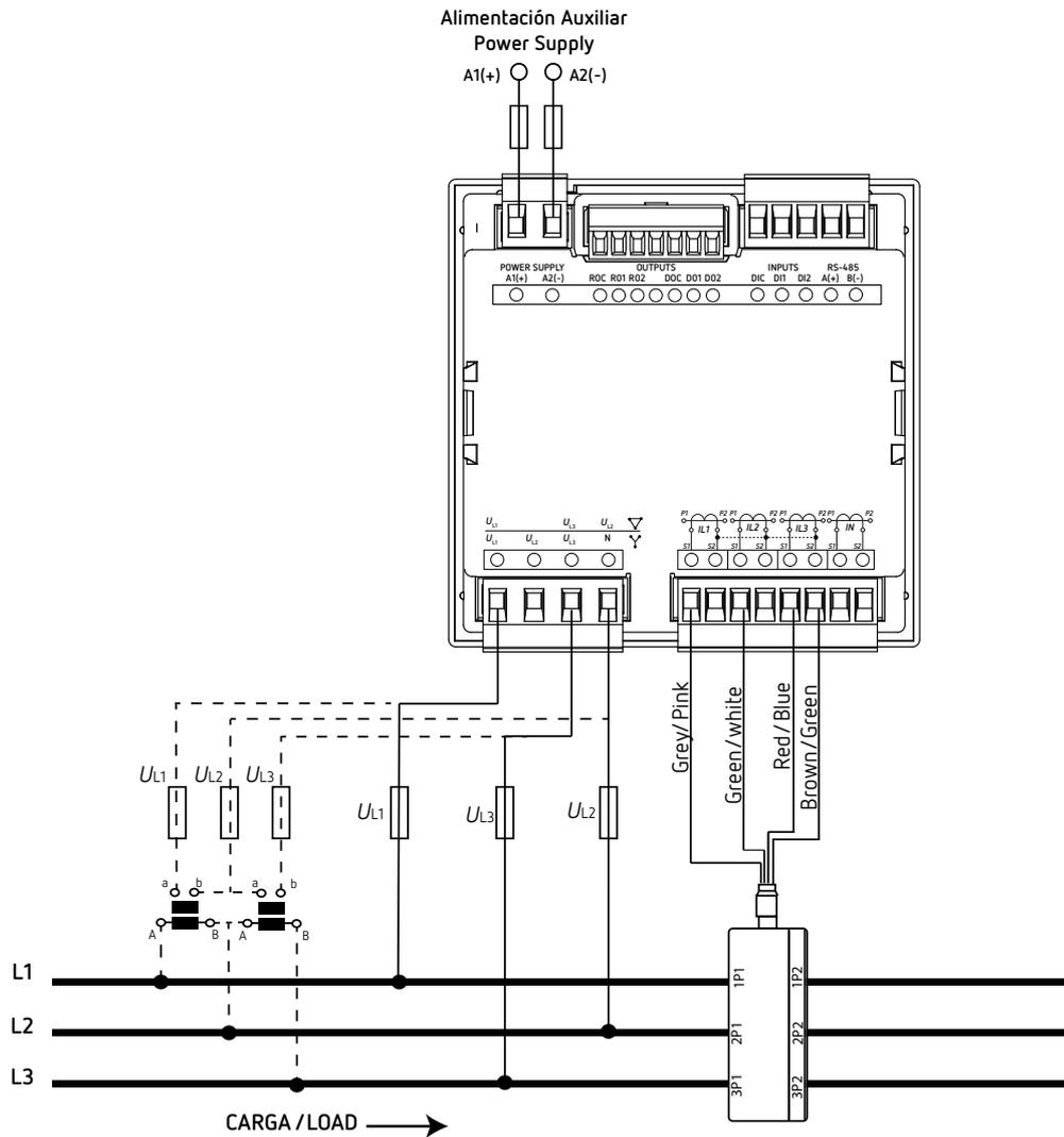
Figura 8: Medida trifásica con conexión a 3 hilos (CVM-C11-MC-IN-485-ICT2).
