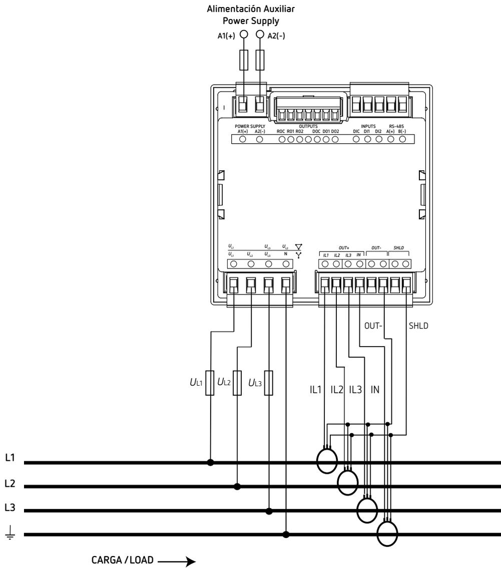
Figura 24: Medida trifásica con conexión a 3 hilos y tierra (CVM-C11-FLEX-IN-485-ICT2).
