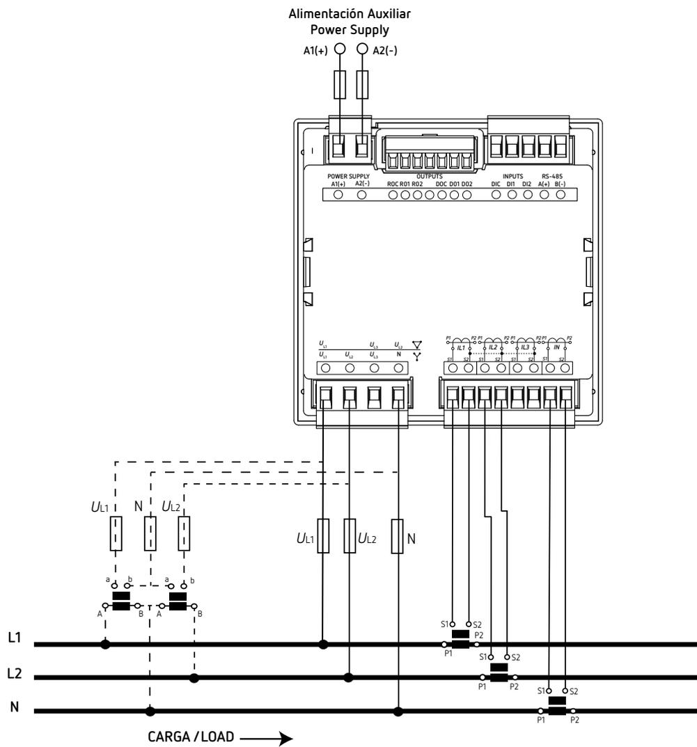
Figura 14: Medida bifásica con conexión a 3 hilos (CVM-C11-MC-IN-485-ICT2).
