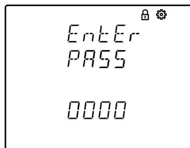
En esta pantalla se introduce el password para poder modificar los parámetros de configuración.
