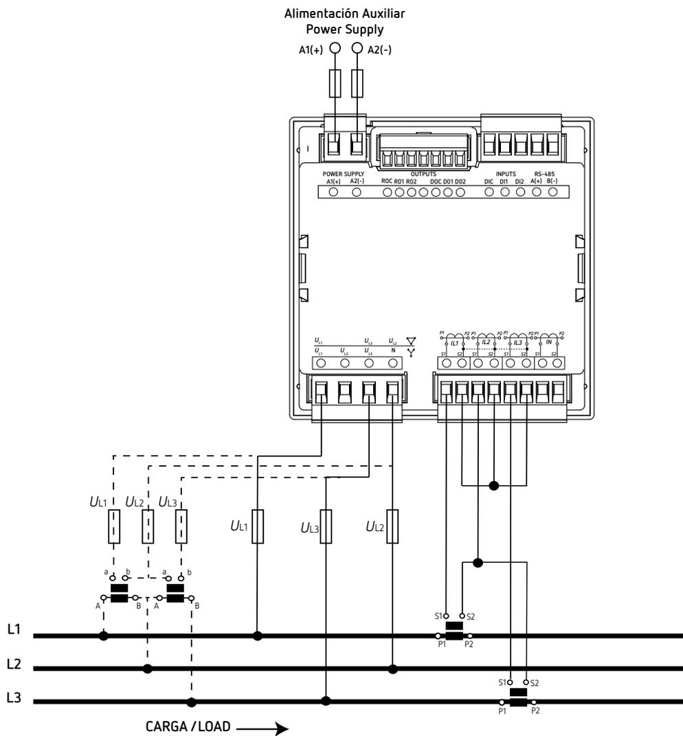
Figura 11: Medida trifásica con conexión a 3 hilos y transformadores en conexión ARON (CVM-C11-MC-IN-485-ICT2).
