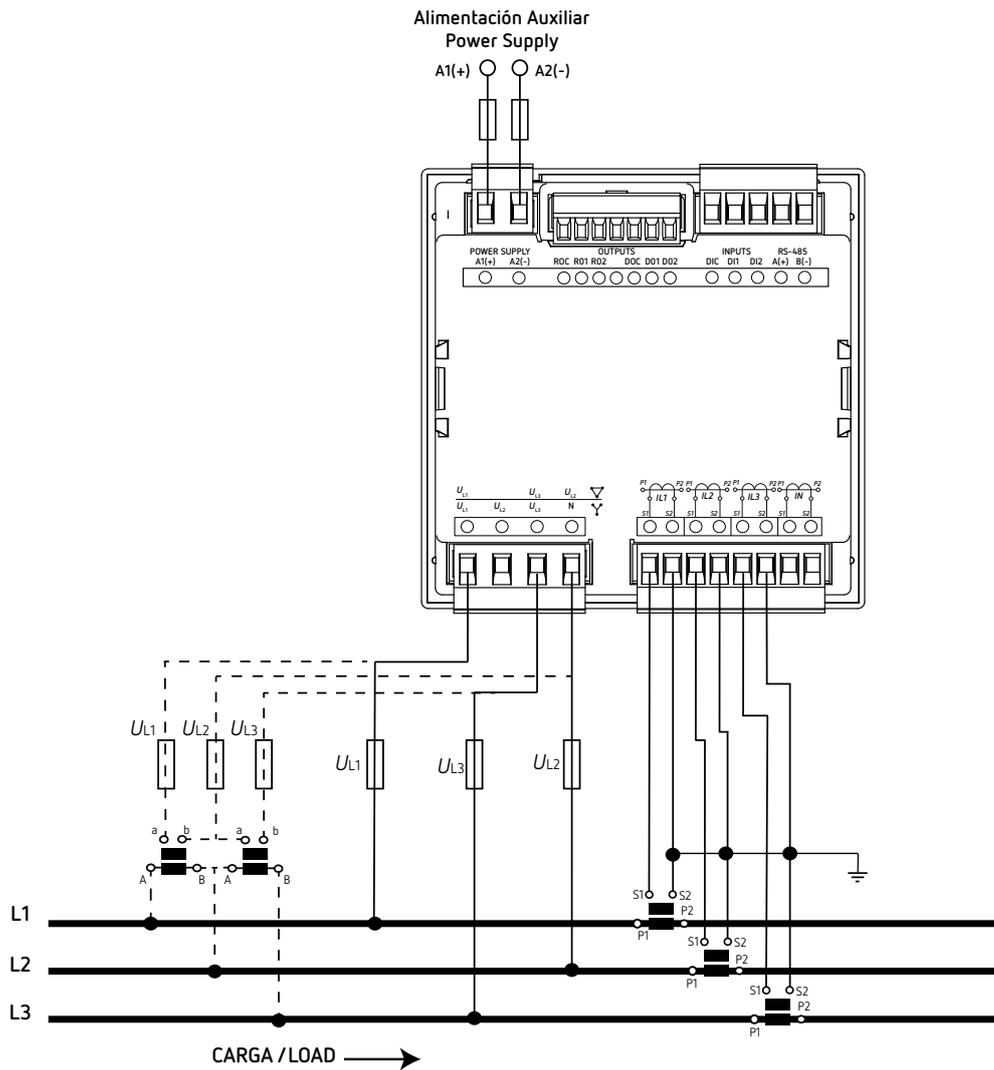
Figura 7: Medida trifásica con conexión a 3 hilos (CVM-C11-ITF-IN-xxx-ICT2).
