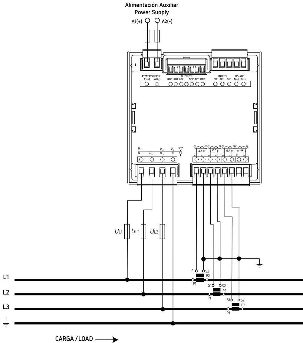
Figura 22: Medida trifásica con conexión a 3 hilos y tierra (CVM-C11-ITF-IN-xxx-ICT2).
