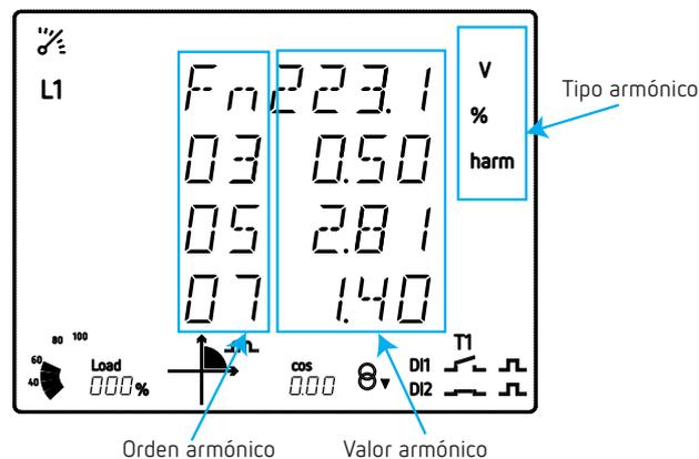
Figura 39: Pantalla de los armónicos del CVM-C11.
