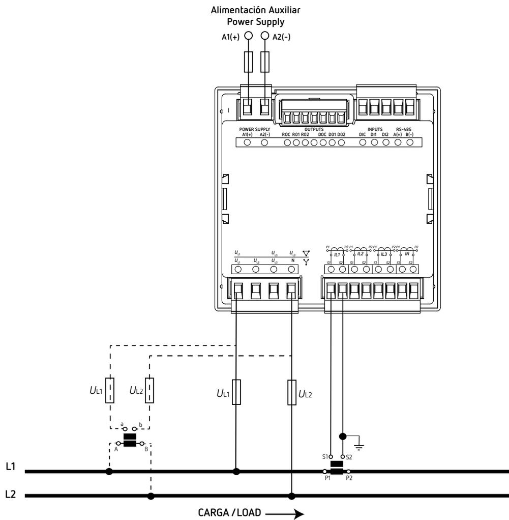
Figura 16: Medida monofásica fase a fase de 2 hilos (CVM-C11-ITF-IN-xxx-ICT2).
