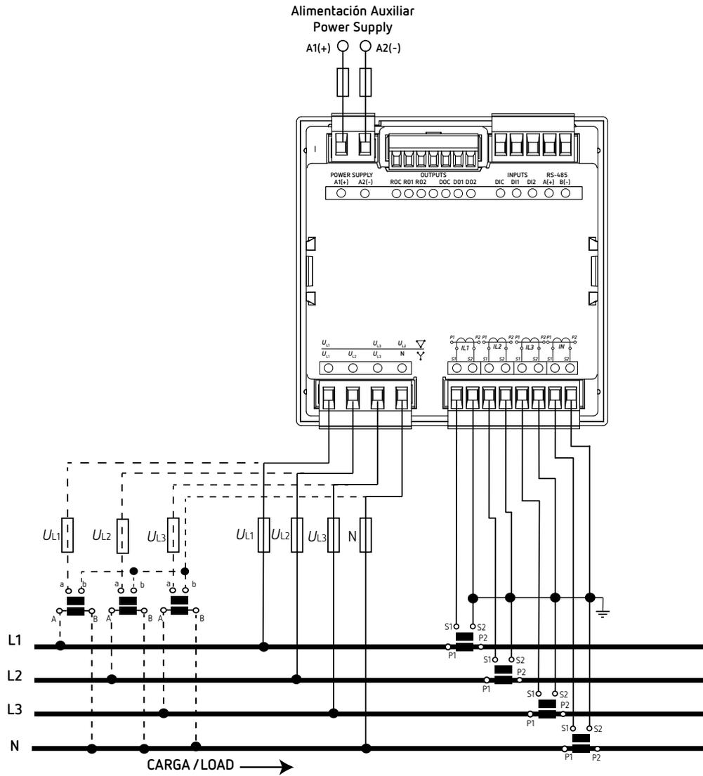
Figura 4: Medida trifásica con conexión a 4 hilos (CVM-C11-ITF-IN-xxx-ICT2).
