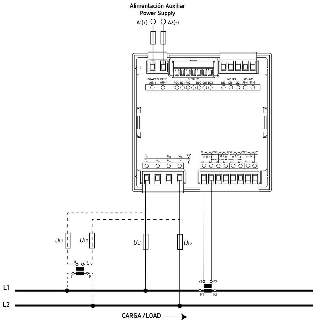
Figura 17: Medida monofásica fase a fase de 2 hilos (CVM-C11-MC-IN-485-ICT2).
