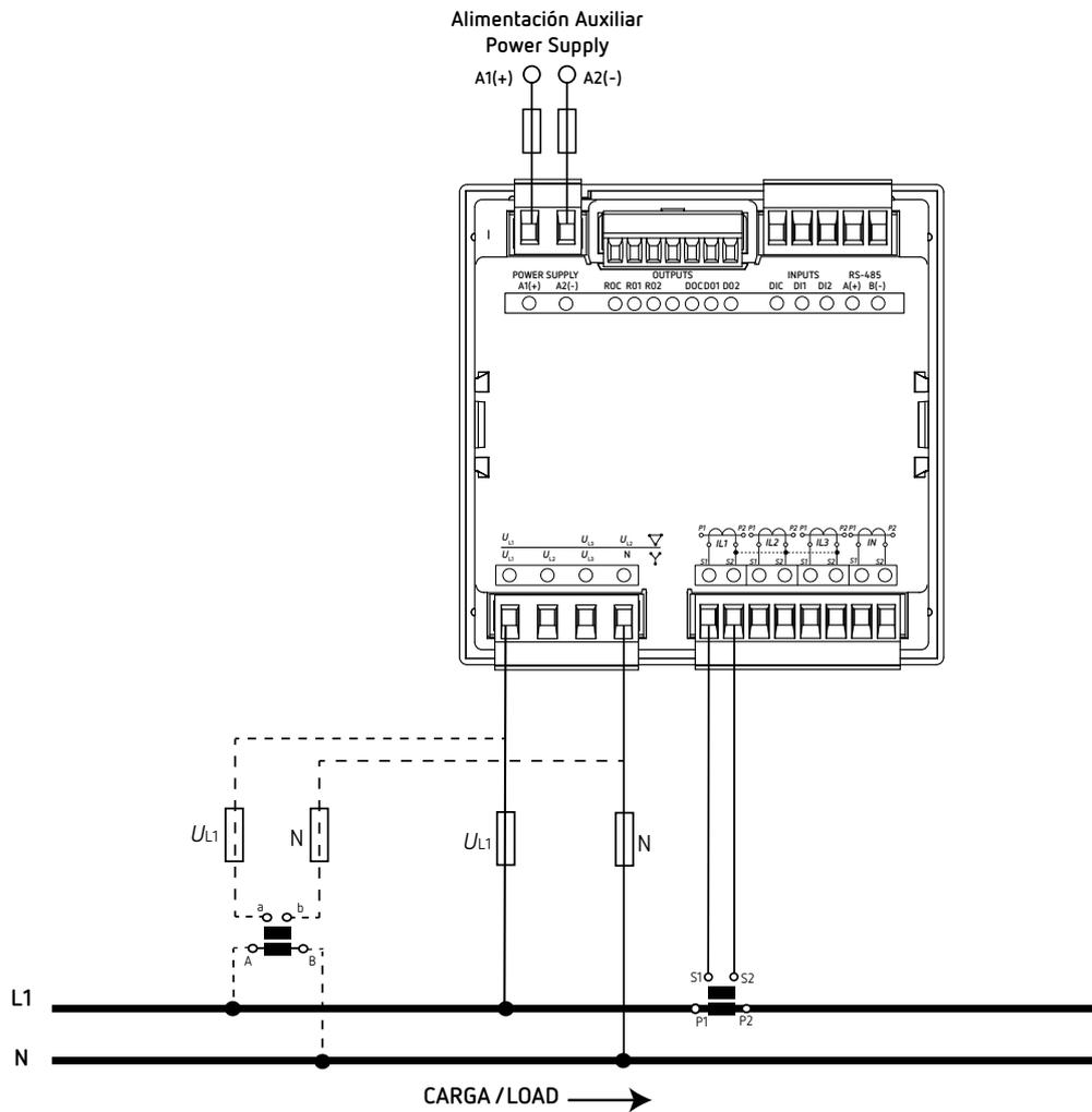
Figura 20: Medida monofásica fase a neutro de 2 hilos (CVM-C11-MC-IN-485-ICT2).
