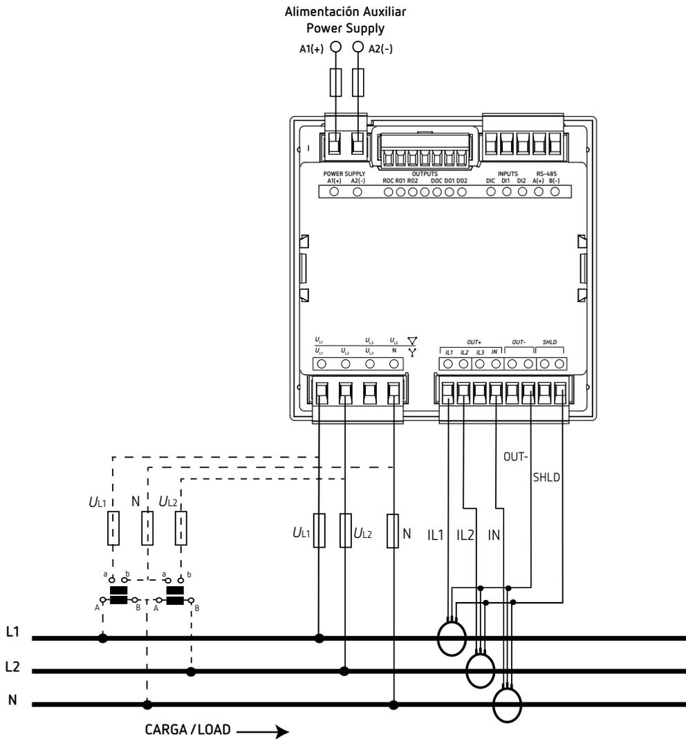
Figura 15: Medida bifásica con conexión a 3 hilos (CVM-C11-FLEX-IN-485-ICT2).
