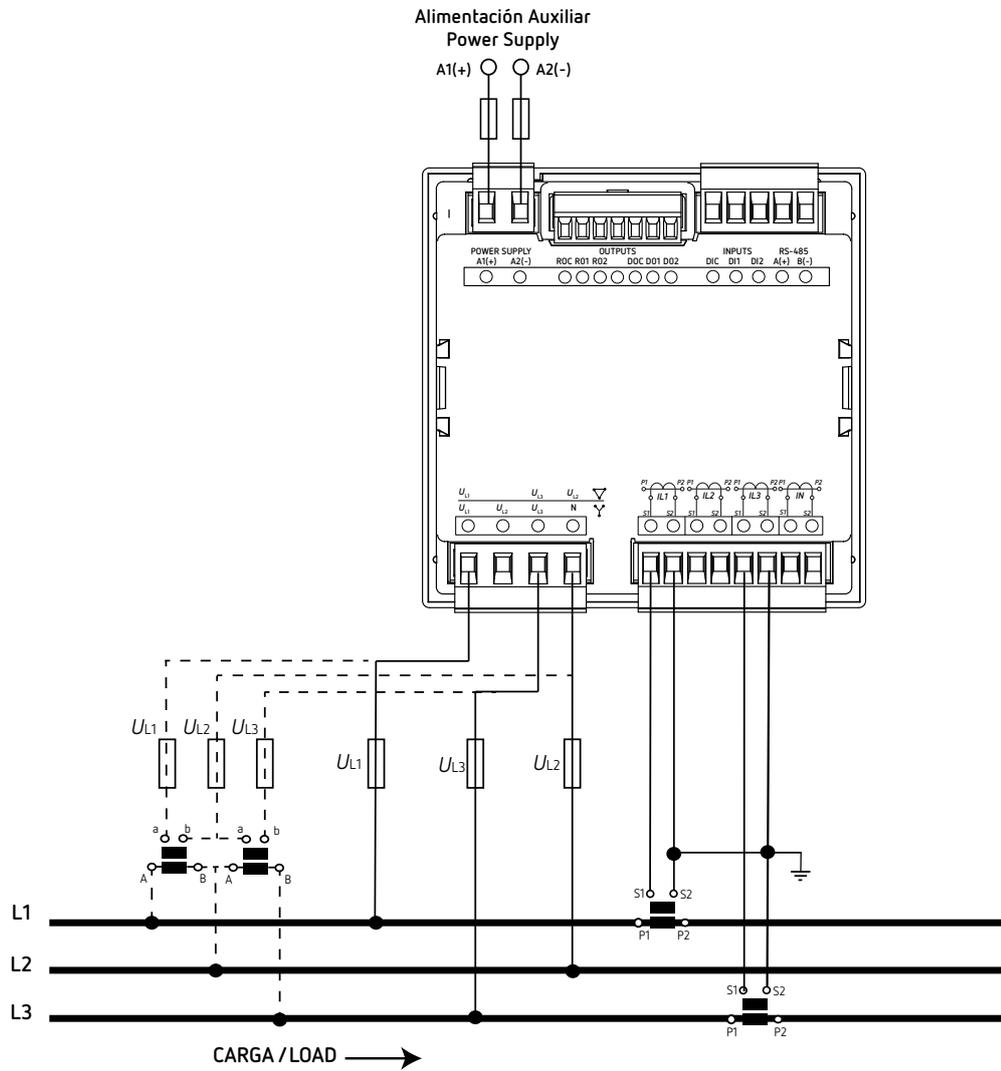
Figura 10: Medida trifásica con conexión a 3 hilos y transformadores en conexión ARON (CVM-C11-ITF-IN-xxx-ICT2).
