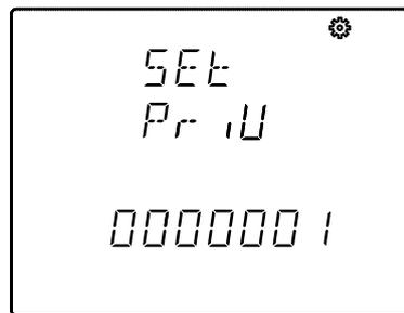
Para poder editar el valor del primario del transformador pulsar la tecla
