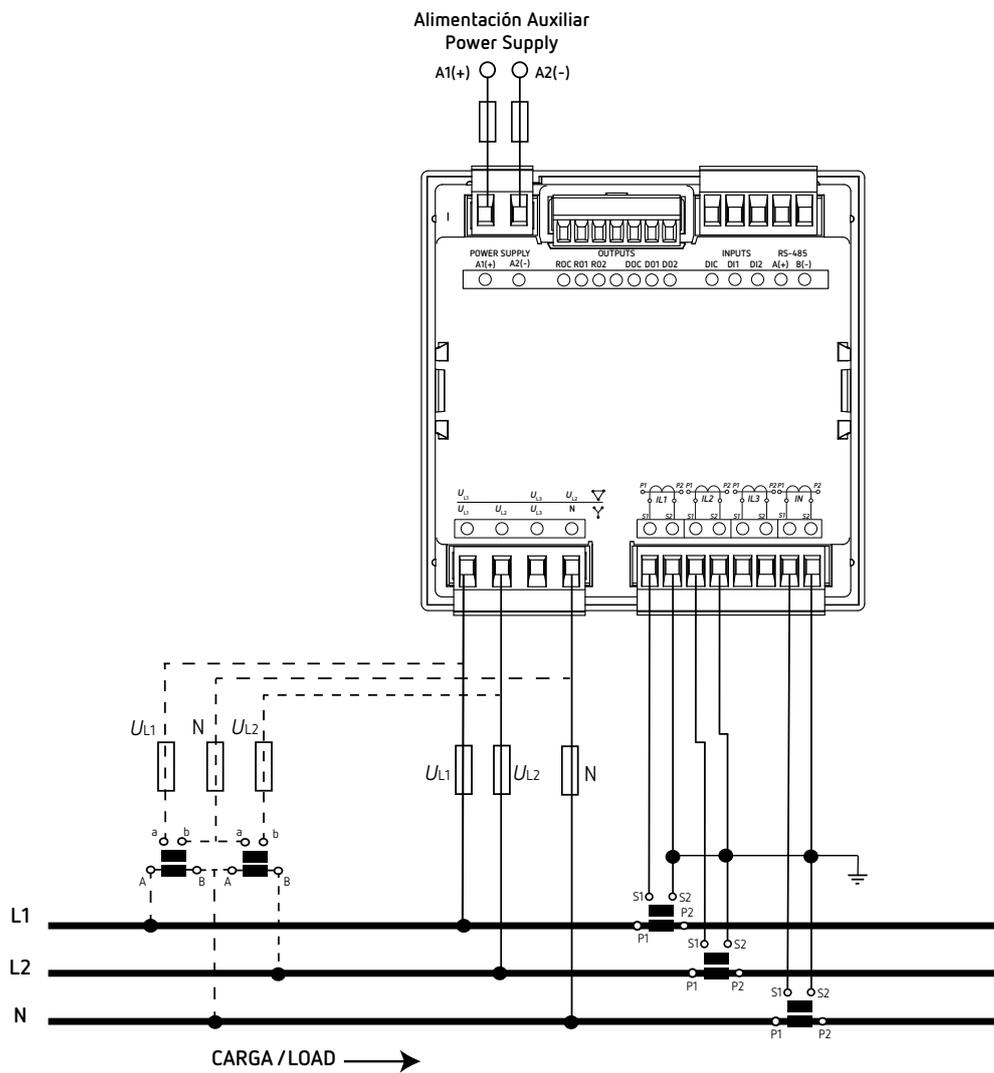
Figura 13: Medida bifásica con conexión a 3 hilos (CVM-C11-ITF-IN-xxx-ICT2).
