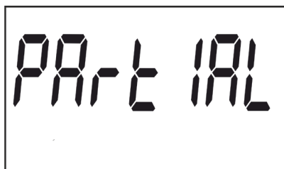
Figura 9: Pantalla principal de las energías parciales.
