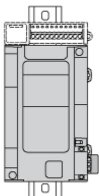
**NOTA:** Los módulos de ampliación se deben montar sobre el Logic Controller.
