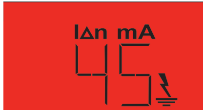
Figura 11: Pantalla de la corriente de disparo ( Ejemplo: disparo por corriente de 45mA)
