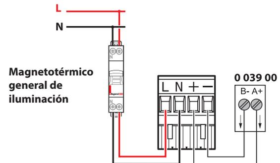
**Nota:** Aunque el consumo de energía de las luminarias de alumbrado de emergencia es bajo, es necesario asegurarse de que la línea dedicada a estas emergencias pueda suministrar la corriente necesaria. A continuación, se muestra la corriente que deberá soportar la línea para 100 emergencias instaladas y según la referencia (para simplificar, se supone que solo se instala un tipo de emergencia por línea)
