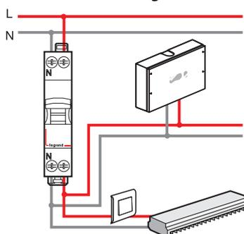
La derivación puede realizarse en el cuadro eléctrico, en el interruptor o en una caja de derivación.
