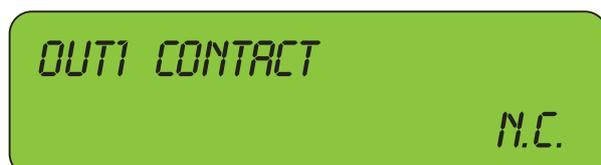
En este punto se selecciona el estado del contacto del relé de salida.
